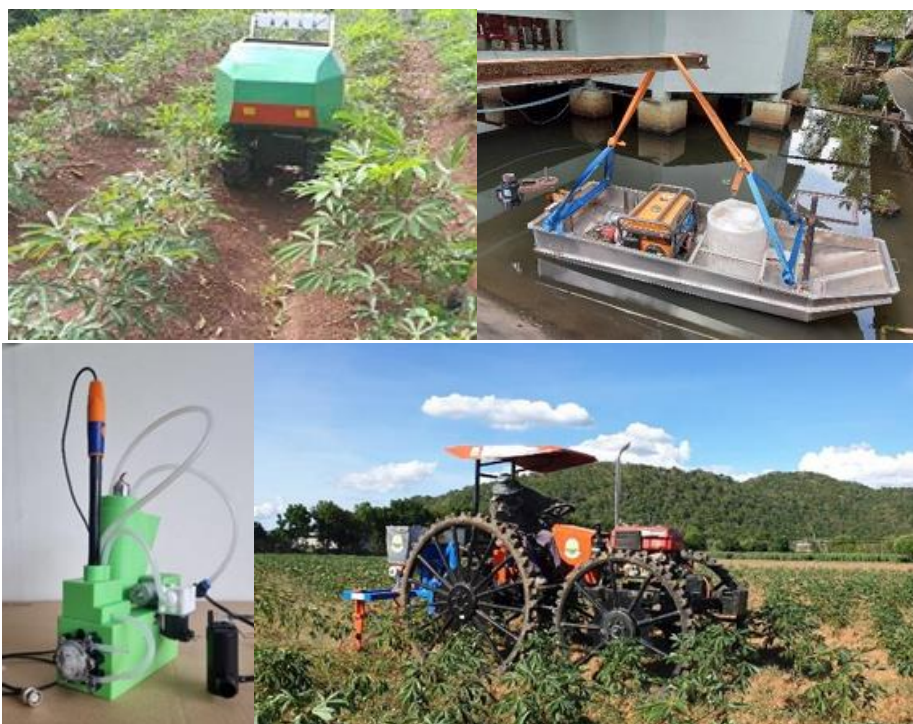
รูปที่ 3.5 หุ่นยนต์เคลื่อนที่อัตโนมัติทางการเกษตรสำหรับการควบคุมวัชพืชในไร่อ้อย
