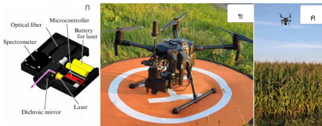
รูปที่ 2.7 แผนผังแสดงไลดาร์เรืองแสงขนาดกระทัดรัดที่ติดตั้งบนโดรนขณะทำการวัดทุ่งข้าวโพด ดัดแปลง จาก (Gudkov et al., 2024)
