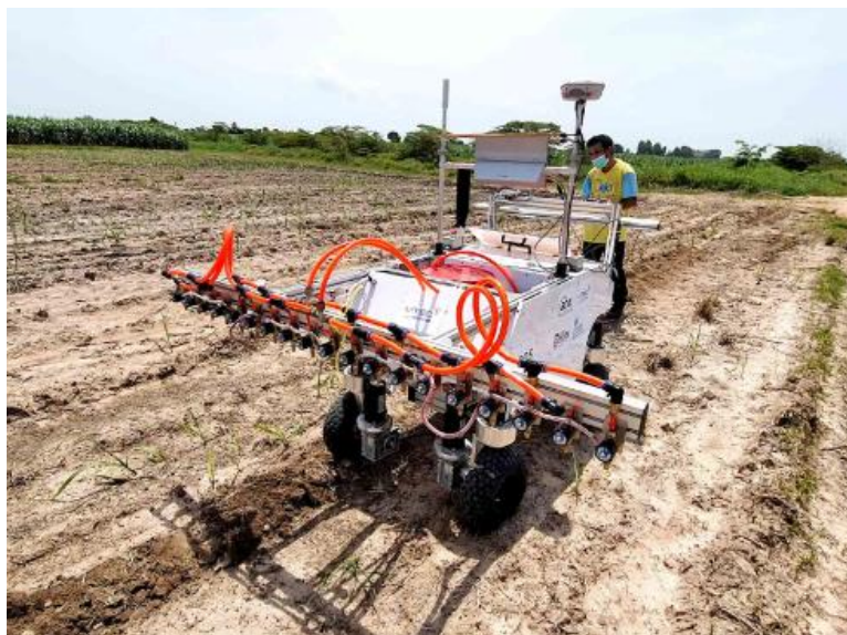
รูปที่ 3.4 หุ่นยนต์เคลื่อนที่อัตโนมัติทางการเกษตรสำหรับการควบคุมวัชพืชในไร่อ้อย
